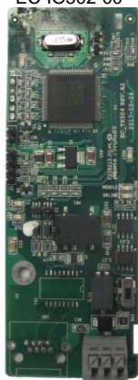
Плата связи управления «главный/подчиненн ый» CANopen/CAN EC-TX505/511
